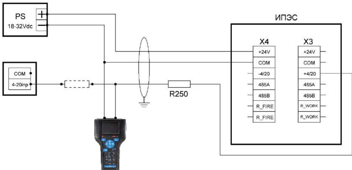
**Примечание:** 250 Ом необходимо для обеспечения правильной работы интерфейса HART, в случае низкого сопротивления 4-20 мА контроллера необязательна установка сопротивления на выходе ИПЭС, возможна установка на входе контроллера.
