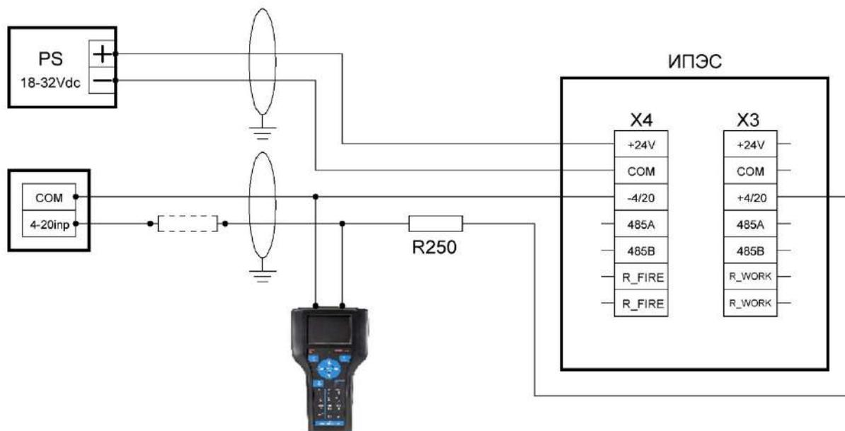
**Примечание:** 250 Ом необходимо для обеспечения правильной работы интерфейса HART, в случае низкого сопротивления 4-20 мА контроллера необязательна установка сопротивления на выходе ИПЭС, возможна установка на входе контроллера.
