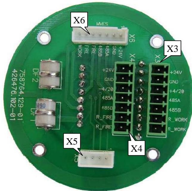
Рисунок 4.1 - Расположение и назначение клемм клеммной платы ИПЭС.
