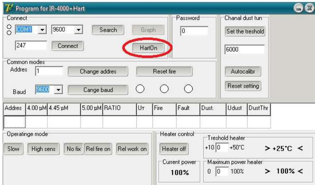
Рисунок 4 - Кнопка для переключения в режим Hart-протокола.
