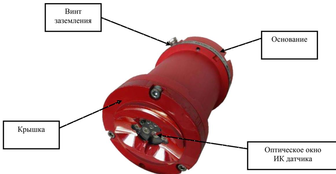
ИПЭС-IR4000 состоит из взрывонепроницаемого корпуса, в котором размещены чувствительные элементы, преобразующие электромагнитное излучение пламени в электрический сигнал, электронных усилителей и фильтров, цифро-аналоговых преобразователей, микропроцессора, элементов индикации, оптопар проверки работоспособности каналов.
